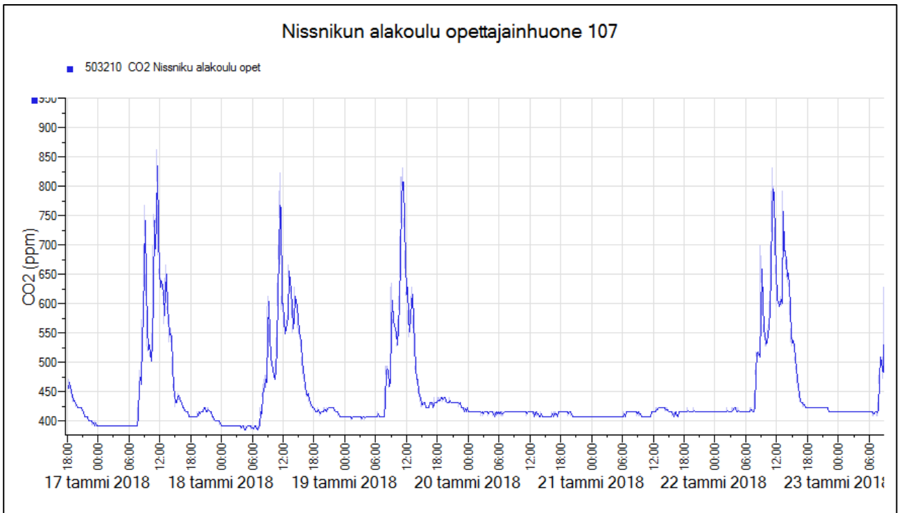
Kuva 7. Hiilidioksidiseuranta 16–23.1.2018 opettajien tilassa 107. Hiilidioksidipitoisuus pysyy hyvällä tasolla koko ajan.
